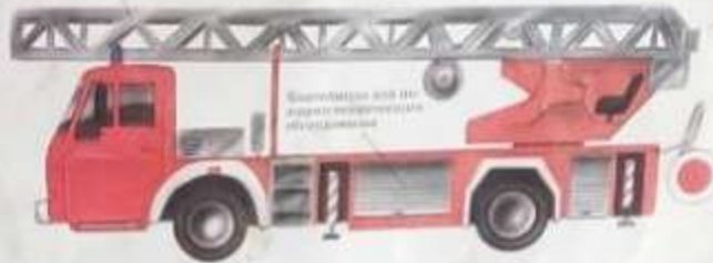
По выдвинутой лестнице можно подняться на высоту до 40 метров.
